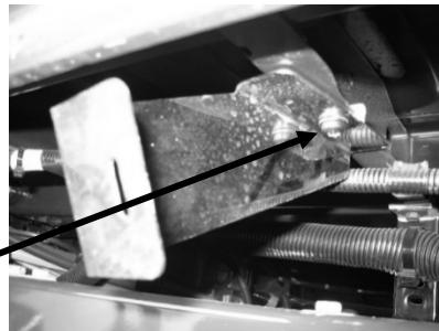
Reemplace con soporte provisto en kit. Sostenga con clips y tornillos
